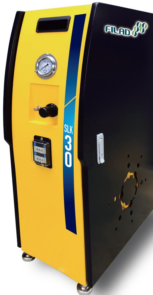
本【油水分離機】是以凸輪所產生的真空吸力及結構特殊的【油水抽取浮盤】，依重量法將水與油之不同比重於靜置狀態下分離，以定時方式，固定時間運轉，可使切削液長期淨化品質，使機台工作效率及廠房環境品質大幅提升。
